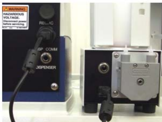
图 19 PriMet Pro 通过 USB Type-B 缆线与 EcoMet Pro 连接
