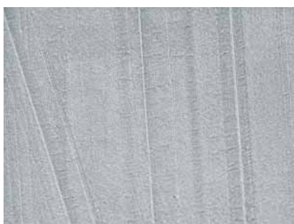
低加速电压图像 通过低加速电压图像可以观察细微结构，在高加速电压图像中，因溶于其中而不能观察。
