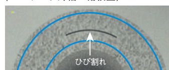
(ベアリング外輪の傷検査)
